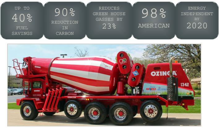
FRONT-DISCHARGE CNG CONCRETE MIXER (RETROFIT)
